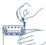
**2. V případě, že jsou zaslepeny i odvětrávací otvory, odstraňte zátky i z těchto otvorů.**
